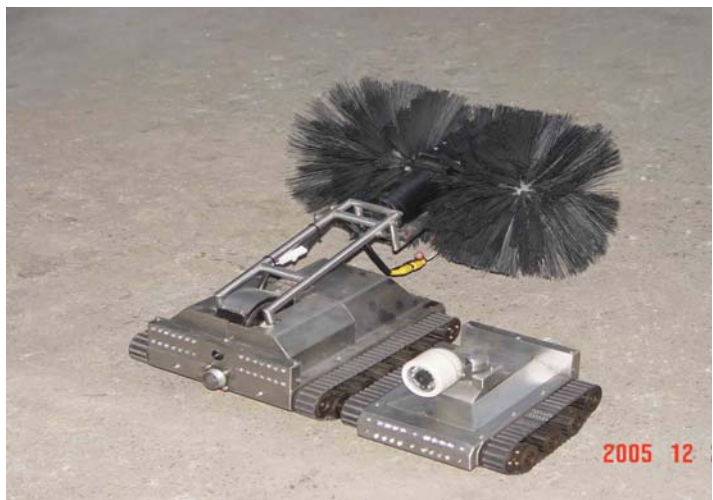
上图：用本公司电机配套制造的自行走中央空调管道探测机器人、清扫机器人 Successful Usage on Self-walking VRV Pipeline Detection Robot and Cleaning Robot
