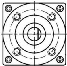
图1 用户安装螺孔的标准位置
